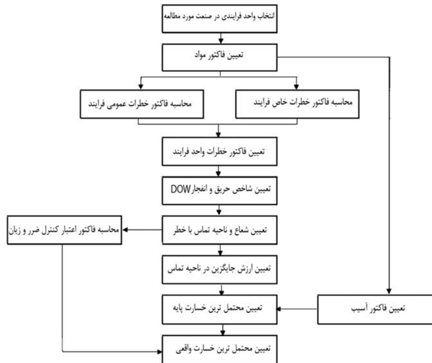
نمودار ۱- مراحل تعیین شاخص حریق و انفجار
