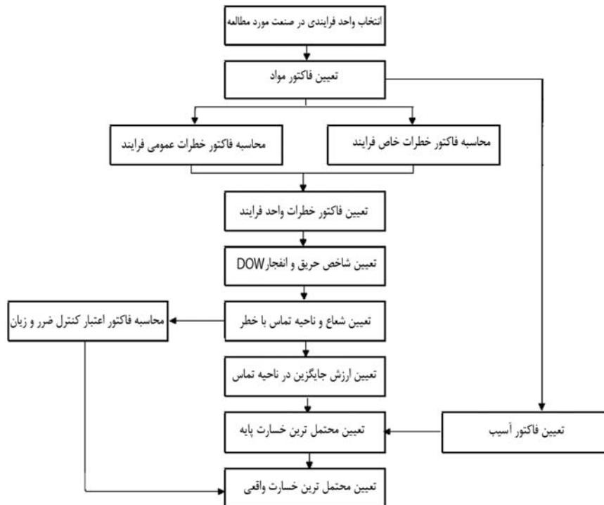
نمودر ۱-مراحل تعیین شاخص حریق و انفجار
