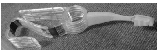
شکل ۳- پرتوتایپ مسواک طراحی شده برای معلولان تتراپلژی (CV-) C5- ساخته شده در کارگاه لیزر دانشگاه علم و صنعت ایران (نگارندگان)
