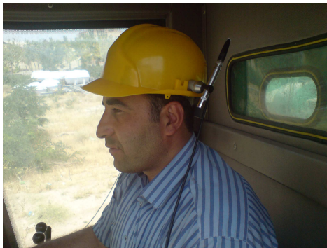
شکل ۱- میکروفن اندازه‌گیری در موقعیت گوش کاربر
