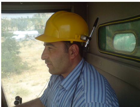
شکل ۱- میکروفن اندازه‌گیری در موقعیت گوش کاربر
