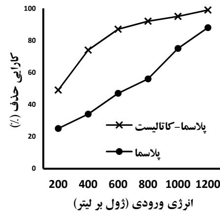
شکل ۵- کارایی حذف روش پلاسمای تنها و روش هیبریدی برای حذف تولوئن (غلظت ۳۰۰ ppm) به صورت تابعی از انرژی ورودی.
