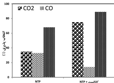
شکل ۷- انتخاب پذیری روش پلاسمای تنها و روش هیبریدی به CO<sub>2</sub> و CO در انرژی ورودی ویژه ۱۰۰۰ ژول بر لیتر (غلظت آلینده ۳۰۰ ppm).
