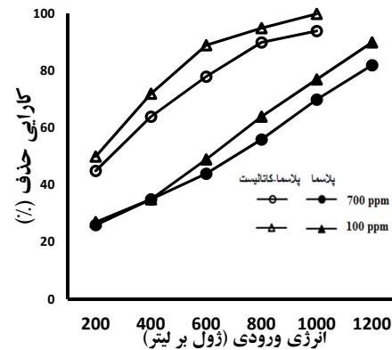
شکل ۶- اثر غلظت ورودی آلینده بر روی میزان حذف تولوئن به عنوان تابعی از انرژی ورودی ویژه.
