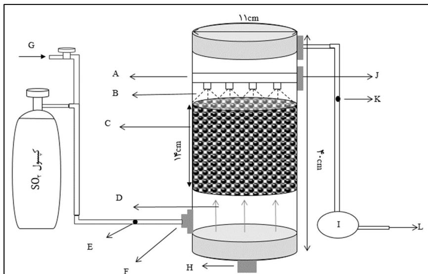
شکل ۱- نمایی از پایلوت آزمایشگاهی اسکرابر بستردار.
