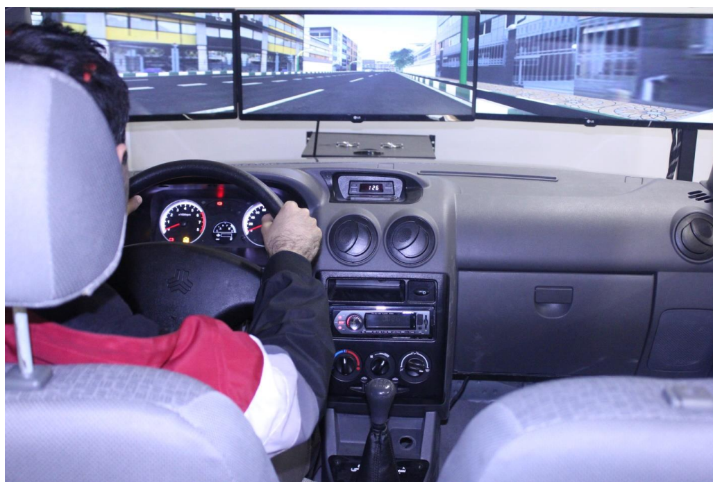
شکل ۱- شبیه ساز رانندگی نصف بدنه خودرو پراید ساخته شده در دانشگاه صنعتی خواجه نصیرالدین طوسی
