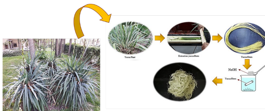
شکل ۱- نحوه استخراج و اصلاح شیمیایی الیاف یوکا
