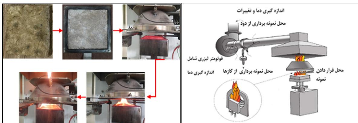
شکل ۱. تصویر شماتیک و واقعی دستگاه گرماسنج مخروطی
