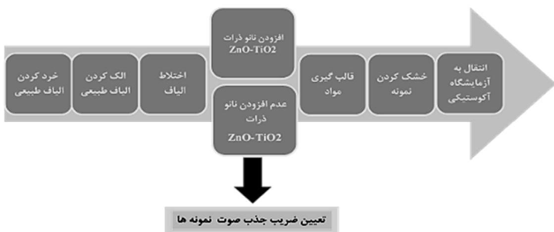
شکل ۲. مراحل ساخت نمونه‌های جاذب صوتی
