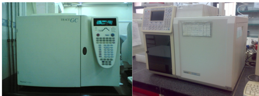
شکل ۱- سیستم‌های کروماتوگرافی گازی مورد مطالعه، سیستم اول (راست)، سیستم دوم (چپ)
