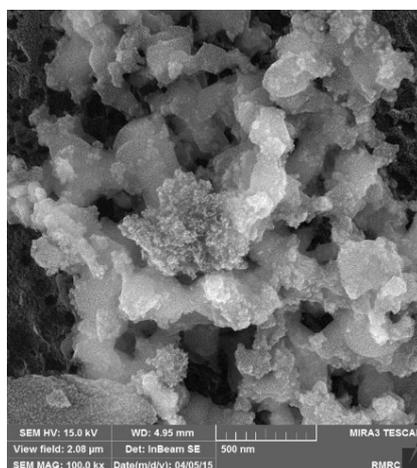
شکل ۲- تصویر میکروسکوپ الکترونی روبشی (SEM) کاتالیست  $ZnO-SnO_2/AC$
