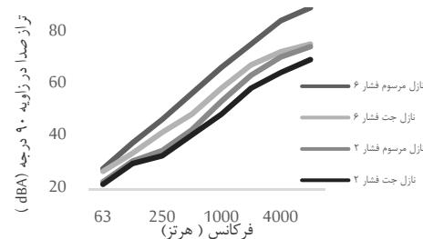
شکل ۳- تراز فشار صوت ناشی از نازل مرسوم و نازل جت چند گانه در فشار ۶ و ۶ بار و فرکانس‌های اکتاو
