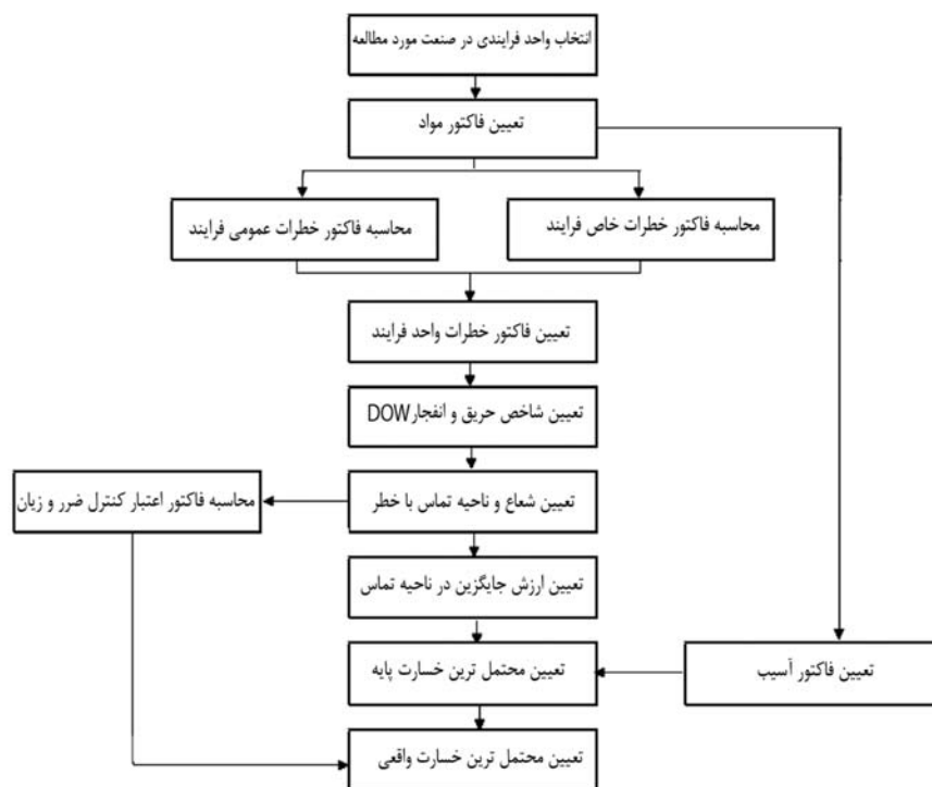
نمودار ۱- مراحل تعیین شاخص حریق و انفجار
