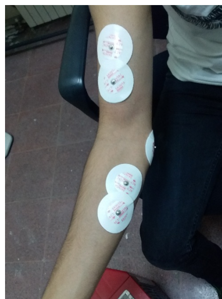
شکل ۲: محل نصب الکترودها بر روی عضلات دوسر بازویی و عضله خم کننده انگشتان و الکترود رفرنس در مطالعه
