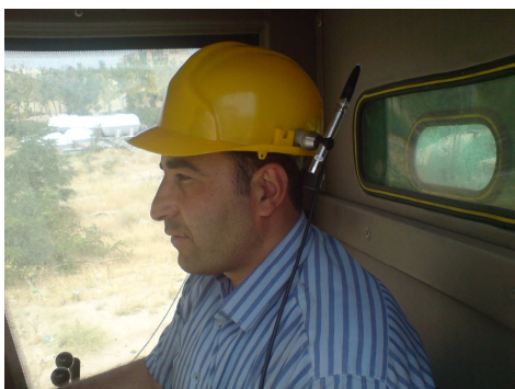
شکل ۱- میکروفن اندازه‌گیری در موقعیت گوش کاربر
