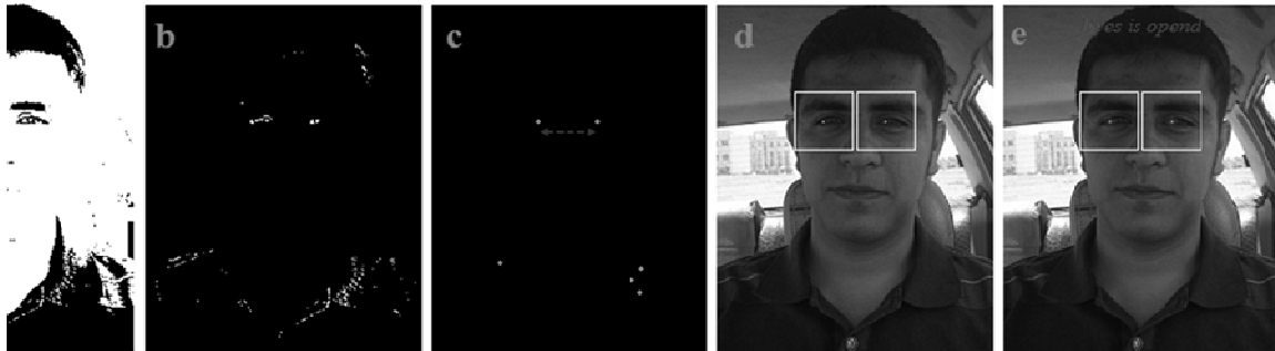
شکل ۶- (a) اعمال آستانه مناسب بر تصویر فریم دریافتی از دوربین، (b) لبه‌یابی و در نظر گرفتن محدوده برای پاک کردن عناصر اضافی، (c) یافتن مراکز ثقل توده‌های پیکسلی و استفاده از معادلات تقارن صورت برای یافتن ناحیه‌ی چشم، (d) رسم هوشمند کادرهای نمایش دهنده‌ی چشم و (e) یافتن مراکز ثقل کادر و متناسب با مختصات مکان مردمک در تصویر لبه.
