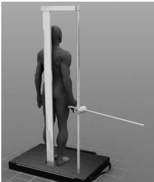
شکل ۸- اندازه گیری ارتفاع برآمدگی بند انگشت
