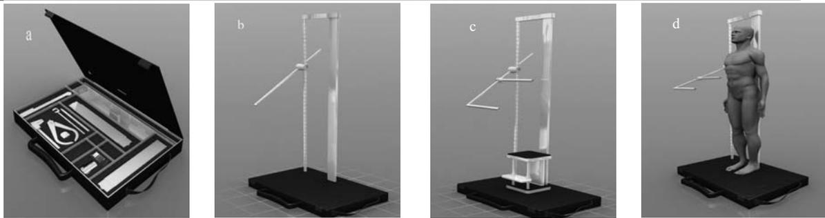
شکل ۱- طرح جدید دستگاه آنترپومتر پرتابل. a: نحوه قرارگیری قطعات در جعبه b: نمای کلی دستگاه
