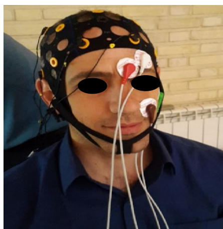
شکل ۲- دو تن از همکاران آتشکار (راست) و دانشگاه (چپ) که در این تحقیق همکاری داشتند و نحوه اتصال کانالها بر روی کلاهک برداشت، به منظور برداشت سیگنالهای مغزی (EEG). ابزار هادی امواج ماهیچه‌های که روی صورت نصب شده است، در ثبت واکنش الکتریکی ماهیچه‌ها (EMG) به صوت انفجار کاربرد داشته‌اند که موضوع تحقیق این مقاله نیست.
