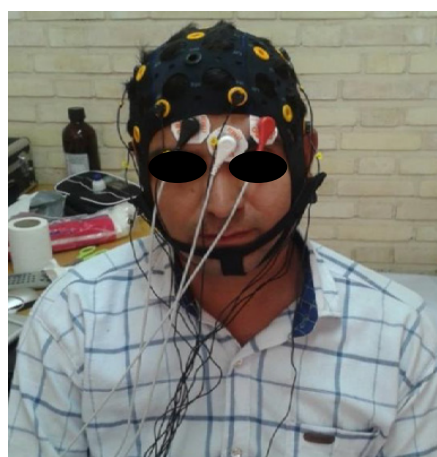
شکل ۲- دو تن از همکاران آتشکار (راست) و دانشگاه (چپ) که در این تحقیق همکاری داشتند و نحوه اتصال کانالها بر روی کلاهک برداشت، به منظور برداشت سیگنالهای مغزی (EEG). ابزار هادی امواج ماهیچه‌های که روی صورت نصب شده است، در ثبت واکنش الکتریکی ماهیچه‌ها (EMG) به صوت انفجار کاربرد داشته‌اند که موضوع تحقیق این مقاله نیست.
