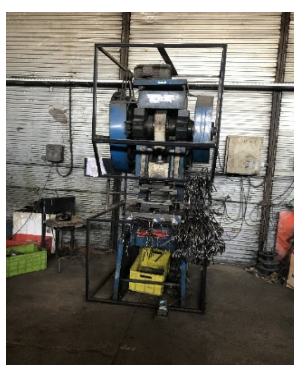
شکل ۳. دستگاه پرس قبل و بعد از محصورسازی آکوستیکی با دریچه باز ۷ درصد
