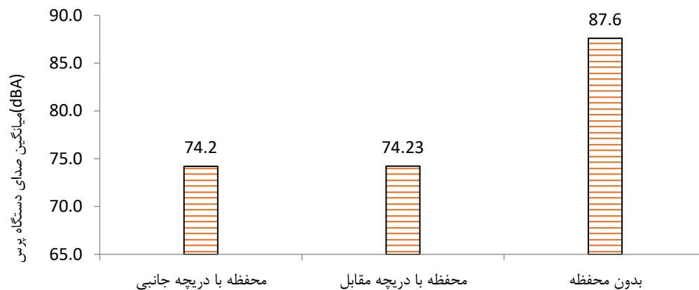
شکل ۷. متوسط صدای دستگاه پرس با تغییر جهت دریچه محصورکننده آکوستیک جزئی
