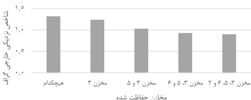
نمودار ۳. تأثیر استفاده از سیستم اسپرینکلر برای مخازن بحرانی آغازگر سناریوهای زنجیره‌ای بر کاهش آسیب‌پذیری مجموعه مخازن.
