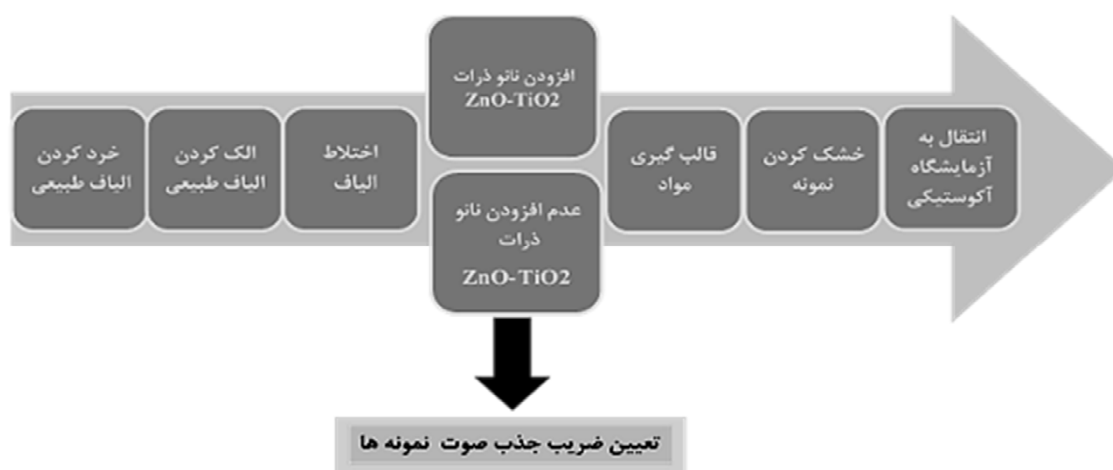
شکل ۲. مراحل ساخت نمونه های جاذب صوتی
