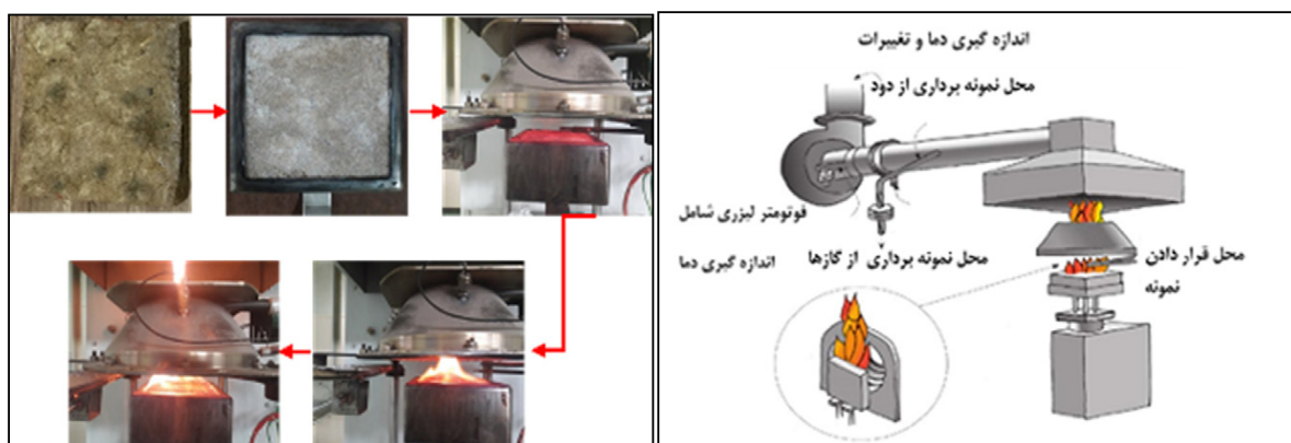
شکل ۱. تصویر شماتیک و واقعی دستگاه گرماسنج مخروطی
