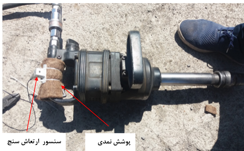
شکل ۲. نحوه بکارگیری پوشش نمدی در دسته آچار بادی
