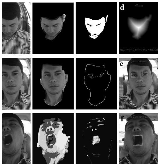
شکل ۱۰- دیاگرام کلی بخش دوم نرم‌افزاری سیستم (a)، (b) و (c) و فریم‌های دریافت شده از دنباله ویدیویی سه‌گانه که در آن‌ها علائم خستگی فرد مشهود است و در فریم دوم حالت چشم به‌صورت باز است، و در (d)، (e) و (f) مراحل پیاده‌سازی الگوریتم‌ها به نمایش در آمده است.
