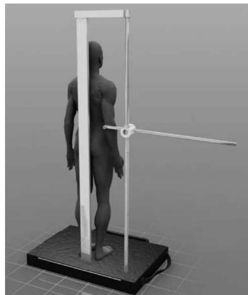
شکل ۷- اندازه گیری ارتفاع آرنج
