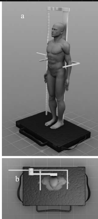
شکل ۱۰- اندازه گیری عرض شانه a: نمای ایزومتریک b: نمای بالا
