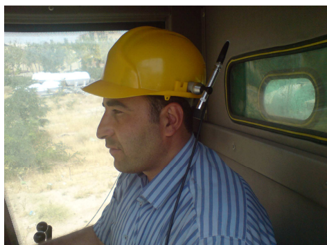
شکل ۱- میکروفن اندازه‌گیری در موقعیت گوش کاربر
