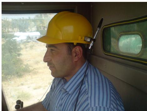
شکل ۱- میکروفون اندازه‌گیری در موقعیت گوش کاربر
