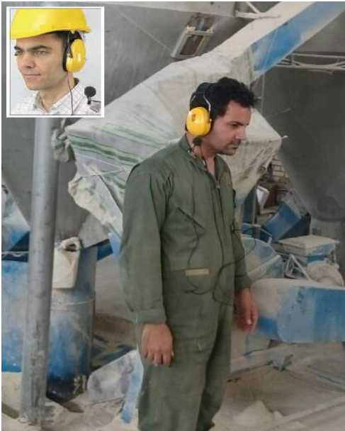
شکل ۱- نحوه قرار گرفتن میکروفن ها در خارج و داخل گوش در شرایط آزمون
