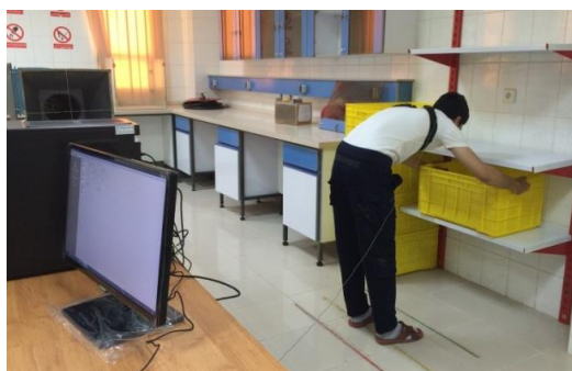
شکل ۱- تصویری از محل قرارگیری جعبه در قفسه‌های طبقه بندی شده بر اساس ارتفاع عمودی. خطوط رنگی در سطح زمین نشان‌دهنده فواصل افقی می‌باشد.
