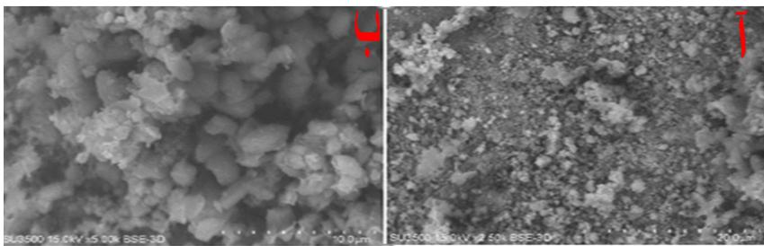
شکل ۳- تصاویر SEM بستر زئولیت ۷ آغشته به نانو ذرات  $\text{TiO}_2$ . (آ) بزرگنمایی  $500\times$  (ب) بزرگنمایی  $2500\times$
