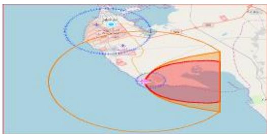
شکل ۴- کنتور نشت CK در میدان اصلی منتهی به نیروگاه و حومه‌ی آن
