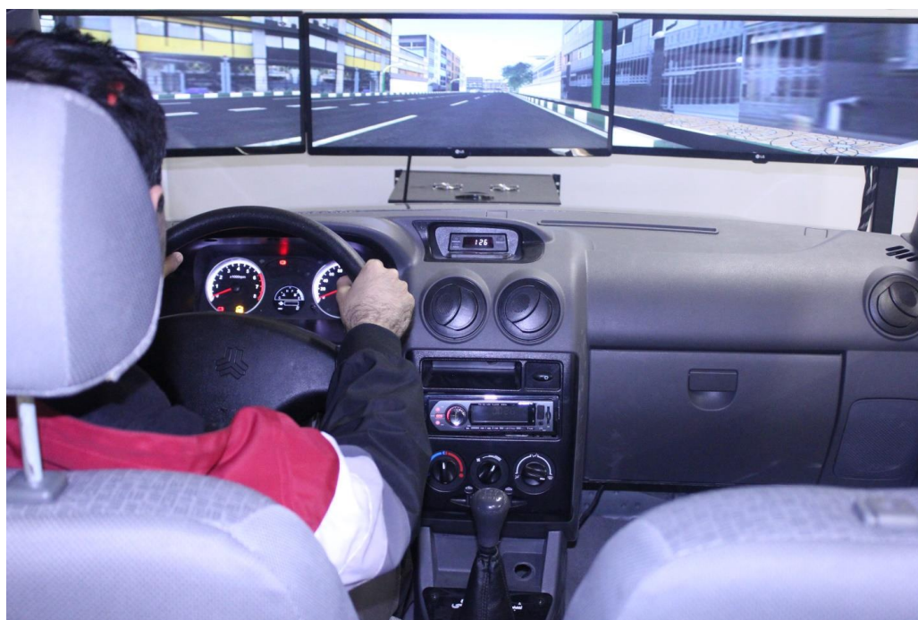
شکل ۱- شبیه ساز رانندگی نصف بدنه خودرو پرآید ساخته شده در دانشگاه صنعتی خواجه نصیرالدین طوسی
