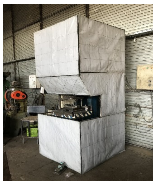
شکل ۳. دستگاه پرس قبل و بعد از محصورسازی آکوستیکی با دریچه باز ۷ درصد
