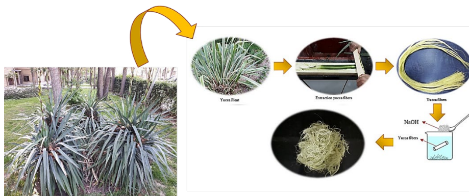
شکل ۱- نحوه استخراج و اصلاح شیمیایی الیاف یوکا
