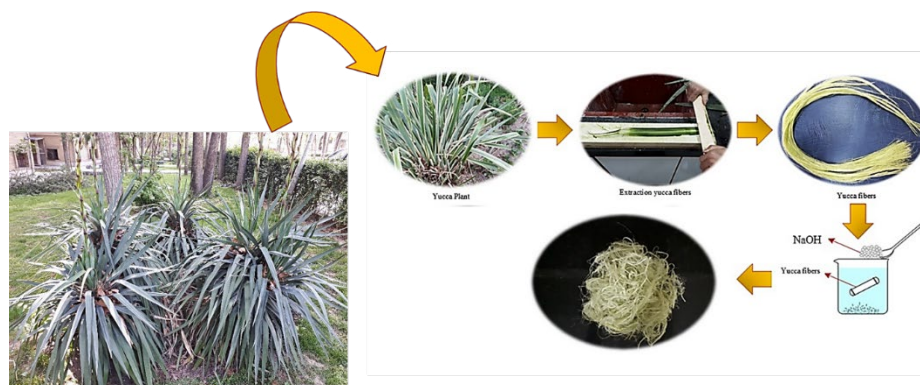
شکل ۱- نحوه استخراج و اصلاح شیمیایی الیاف یوکا
