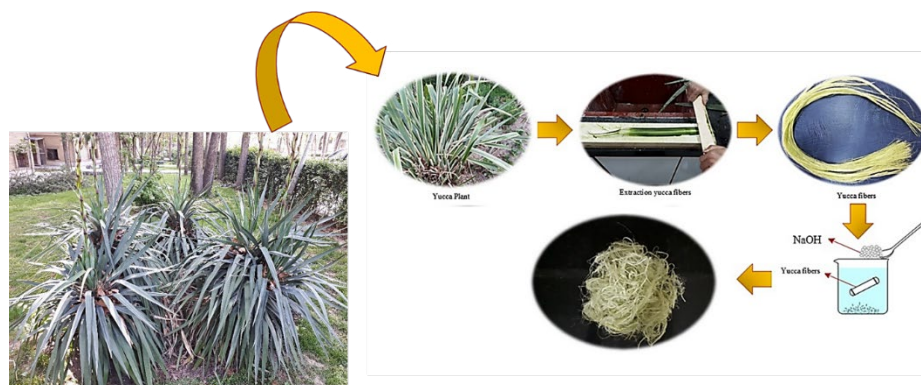
شکل ۱- نحوه استخراج و اصلاح شیمیایی الیاف یوکا
