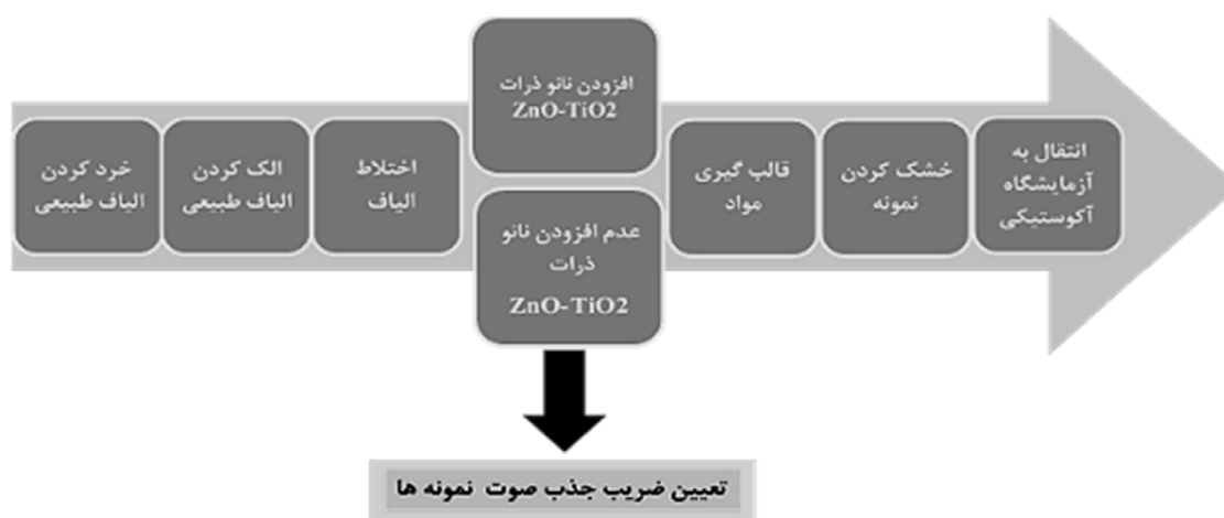
شکل ۲. مراحل ساخت نمونه های جاذب صوتی
