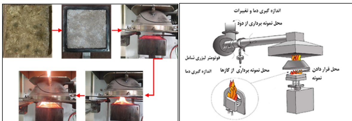
شکل ۱. تصویر شماتیک و واقعی دستگاه گرماسنج مخروطی
