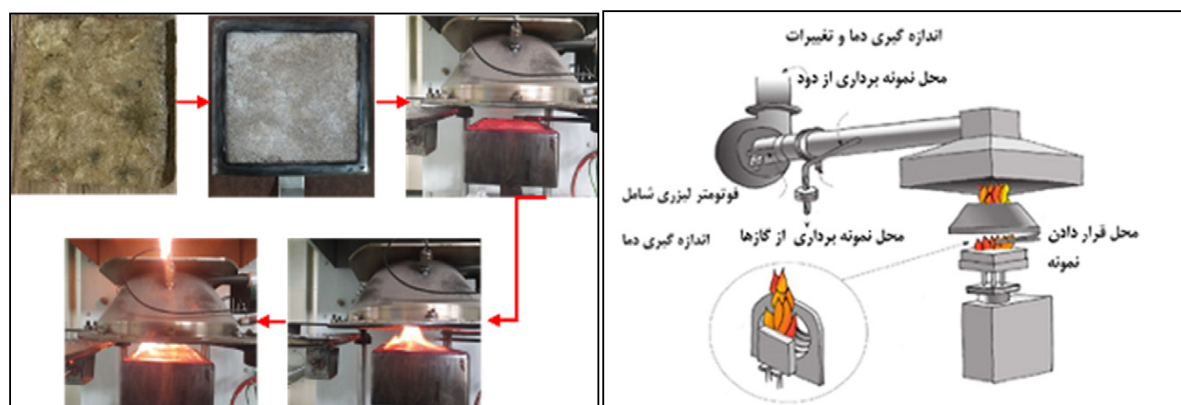
شکل ۱. تصویر شماتیک و واقعی دستگاه گرماسنج مخروطی
