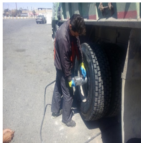
شکل ۱. سمت چپ تصویر آچار بادی سمت راست شاغل در حال کار با آن
