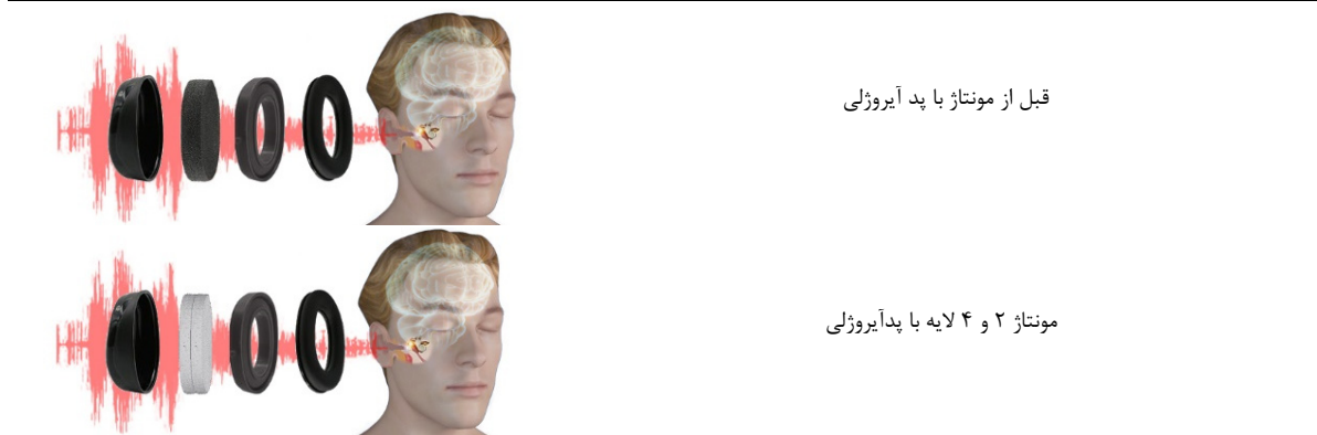
جدول ۲. اجزای ایرماف قبل از مونتاژ و بعد از مونتاژ ۲ و ۴ لایه با پد آبروژلی
