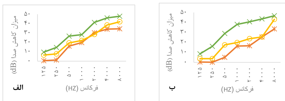
نمودار ۲. مقایسه NR ایرماف‌های مورد بررسی الف) بعد از مونتاز دو لایه ب- مونتاز چهار لایه از پدهای آبروژلی (ستاره: ایرانی، دایره توخالی: تایوانی، ضربدر: آمریکایی)
