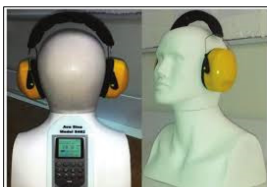
شکل ۲. نحوه قرارگیری گوشی ایرماف بر روی مانکن آکوستیکی برای تعیین میزان کاهندگی صدا
