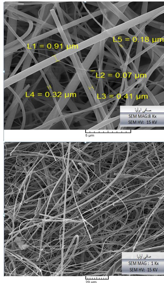
شکل ۲- تصاویر SEM از بستر اولپا استفاده شده. تصویر سمت راست: سطح مقطع از صافی تهیه شده، به همراه آنالیز و اندازه گیری قطر فیبر توسط نرم افزار Image pro plus.
