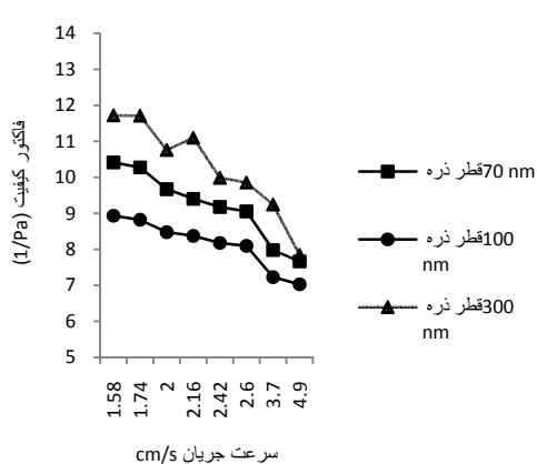
شکل ۷- فاکتور کیفیت (QF) صافی اولپا برای ذرات در گستره ۷۰، ۱۰۰ و ۳۰۰ نانومتر در سرعت جریان ۱.۵۸ تا  $cm.s^{-1}$
