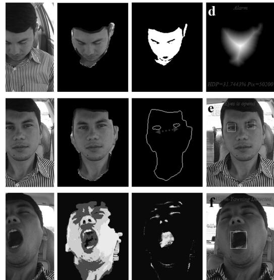
شکل ۱۰- دیاگرام کلی بخش دوم نرم‌افزاری سیستم (a) و (b) فریم‌های دریافت شده از دنباله ویدیویی سه‌گانه که در آن‌ها علائم خستگی فرد مشهود است و در فریم دوم حالت چشم به صورت باز است، و در (c)، (d) و (e)، (f) مراحل پیاده‌سازی الگوریتم‌ها به نمایش در آمده است.
