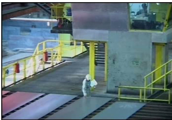
تصویر ۱: ثبت کد بر روی ورقه های نورد شده در بخش بسترهای خنک کننده
